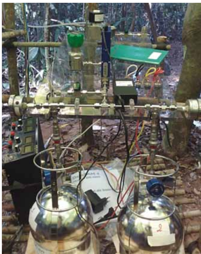
Figura 3: Instalação de sistema para amostragem de gases no campo durante a combustão de biomassa.
