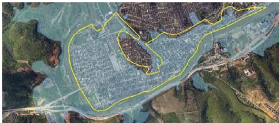
Figura 01: Simulação de eventos de cheias em Pernambuco comparados com marcas levantadas em campo.
