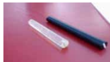
Protótipos dos elementos sensores de cerâmica porosa de ZrO_2-TiO_2 , produzidos e caracterizados nesta etapa do trabalho, para monitoramento de: a) umidade do ar e b) umidade de solo.
