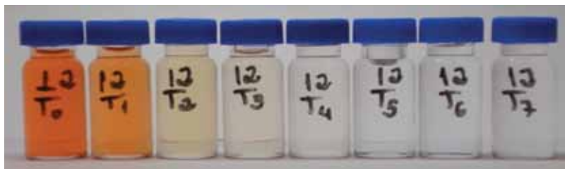
Eficiência dos eletrodos DDB para a remoção da cor das soluções contendo o corante R016.
