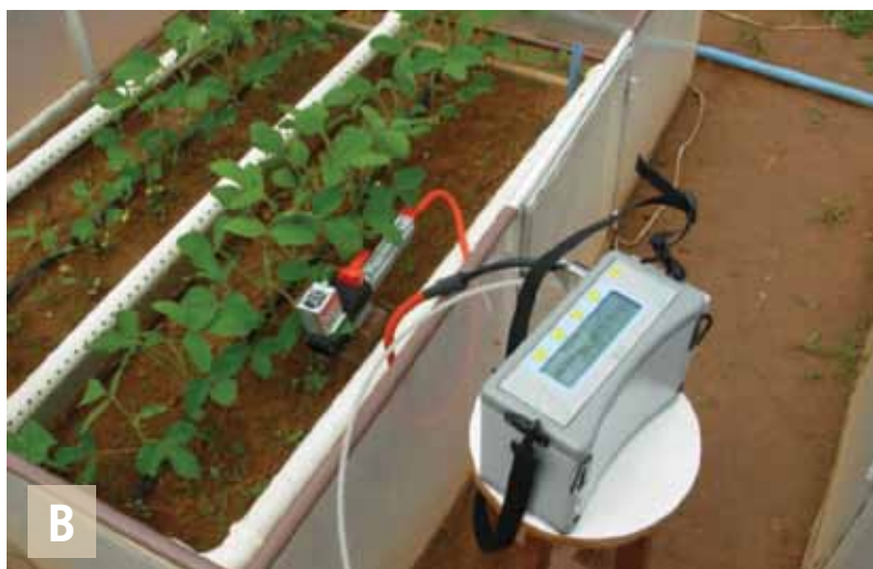
A: Câmaras de topo aberto desenvolvidas para aumentar a [\text{CO}_2] no ambiente; e B: Ensaio com o IRGA (Infrared Gas Analyser) LCPro + para estimar o ótimo ponto de radiação para a fotossíntese
