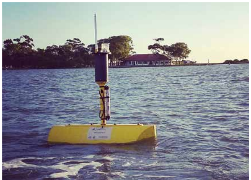
Figura 1: Plataforma de monitoramento dos parâmetros da água (River-Lobo) fundeada no Estuário da Lagoa dos Patos, Rio Grande (RS), vinculada ao SiMCosta.
