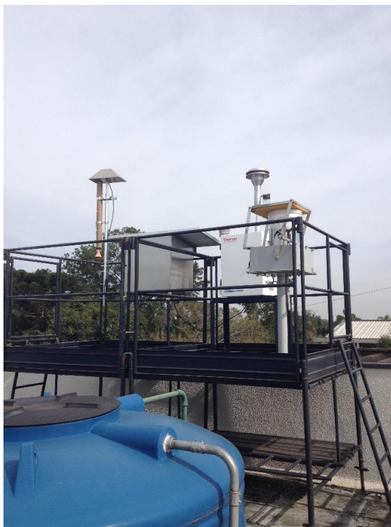
Figura 7 - Plataforma com instrumentação para coleta de amostras atmosféricas INPE – São José dos Campos
