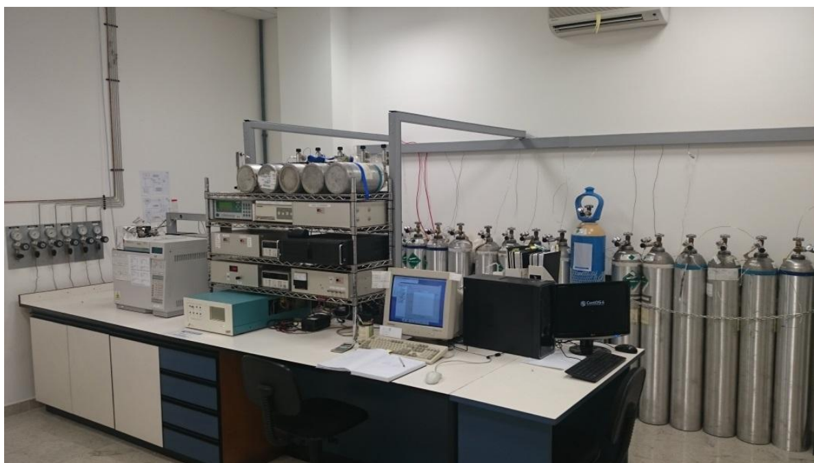
Figura 4 - Laboratório de Análise de Gases de Efeito Estufa de alta precisão, com medidas de \text{CO}_2 , \text{CH}_4 , \text{N}_2\text{O} , \text{CO} , \text{SF}_6 e \text{H}_2
